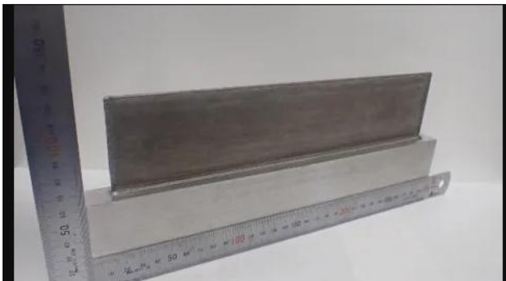
用于增材制造的镁合金样品（来源：日本宇宙航空研究开发机构）
