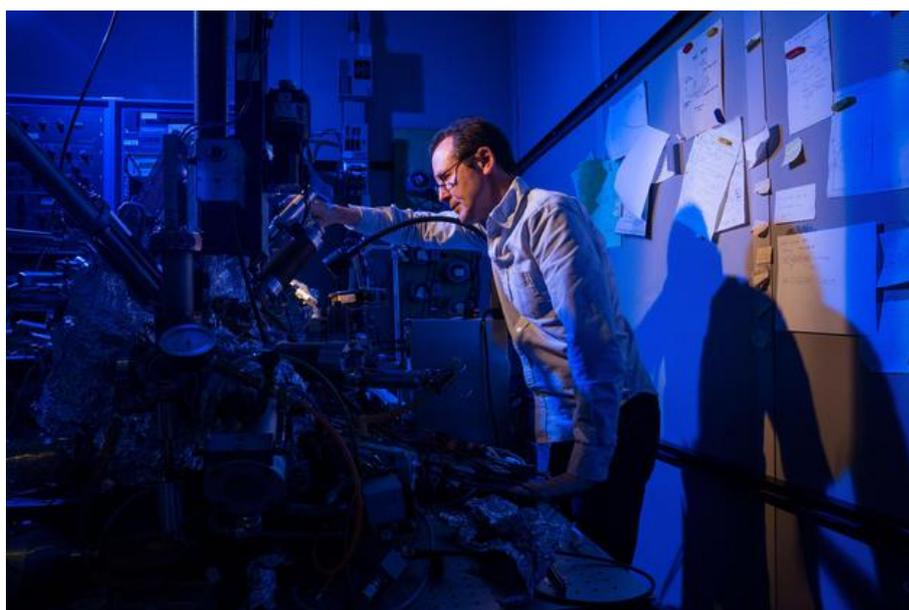
IBM 研究员克里斯-鲁茨的单原子存储实验仪器
