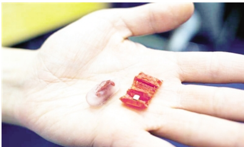
图为胶囊和展开的折叠机器人设备。
