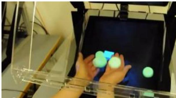
Holodesk 通过一个全透明显示器加一个 Kinect 摄像机，能让用户产生直接触摸并操纵三维图像的错觉。投影仪将三维景物的虚像通过一个半镀银镜，在空间里与真实世界交汇结合。在演示录像中，用户会看到像实物一样有质感的小球及其他形状的物体，把手放在玻璃下面以想要的方式移动，就像是真实地在移动这些物体，比如把小球铲入杯子。
