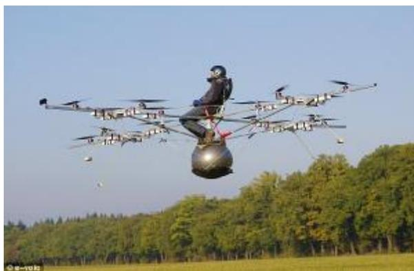
试飞照片显示，它看上去就像一个人坐在弹跳球上，周围被遥控直升机模型环绕。实际上，它由 4 组 16 个水平旋翼组成，每个旋翼由电脑控制，因此飞行员坐在位于中心的底座上，仅用无线控制器就可操控驾驶，如同玩电子游戏一样。座位下方的球主要起减震作用。
