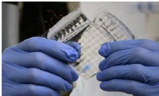
研究小组设计了一款透明，可拉伸的传感器，它可以重复使用而不会起皱，每次触碰后都会立即回复原状。科学家们希望这项技术未来可以在医学上得到应用，如设计可以调节紧绷感的绷带，甚至可以用来制作人造皮肤，帮助病人恢复触觉，或者设计具有触觉的机器人。当然，在传统的触摸屏和计算机方面，它将更加具有用武之地。
