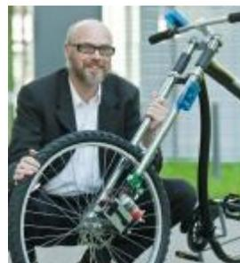
装置是无线的。用无线系统刹车时，骑车人只需捏紧车把上的橡皮手柄，上面安装了压力传感器。捏的力度越大，给前轮刹车系统施加的压力也就越大。自行车车把上还安装有香烟盒大小的信号发送器，信号接收器则安装在自行车叉架的末端，负责把来自手柄的无线信号转变为对前轮施加的机械压力。
